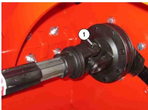
Рис. 60. Боковой карданный вал с фрик- ционной муфтой 1 Фрикционная муфта
