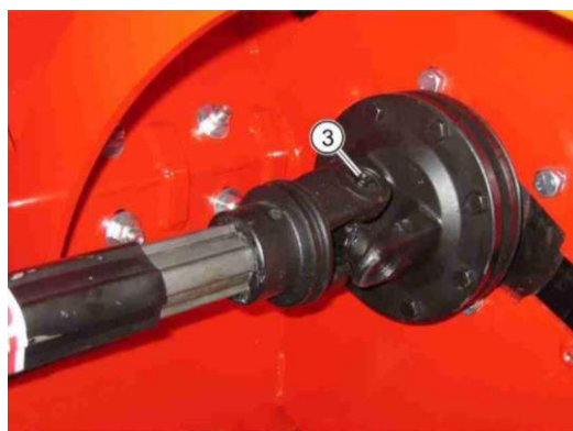
Рис. 53. Точки смазки привода 3 Крестовина на внутренней стороне бокового карданного вала
