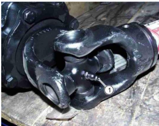
Рис. 50. Точки смазки приводного карданного вала 1 Крестовина
