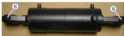
Рис. 55. Точки смазки цилиндра верхнего рычага 6 Шарнирная проушина
