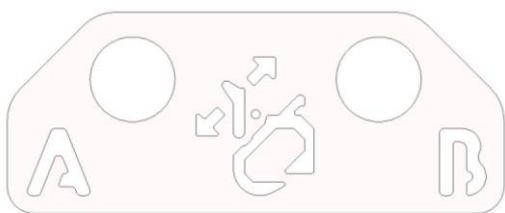
Рис. 42. Разъемы подключения гидравлического устройства прижима
