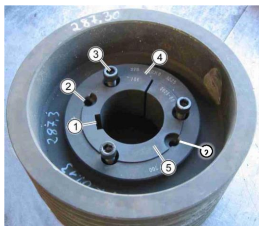
Рис. 66. Установка конической закрепительной втулки в ременной шкив
